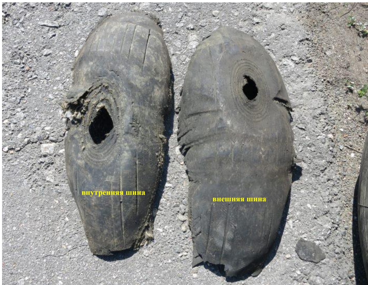
Рис. 13. Фрагменты внутренней и внешней шин правой основной стойки шасси
