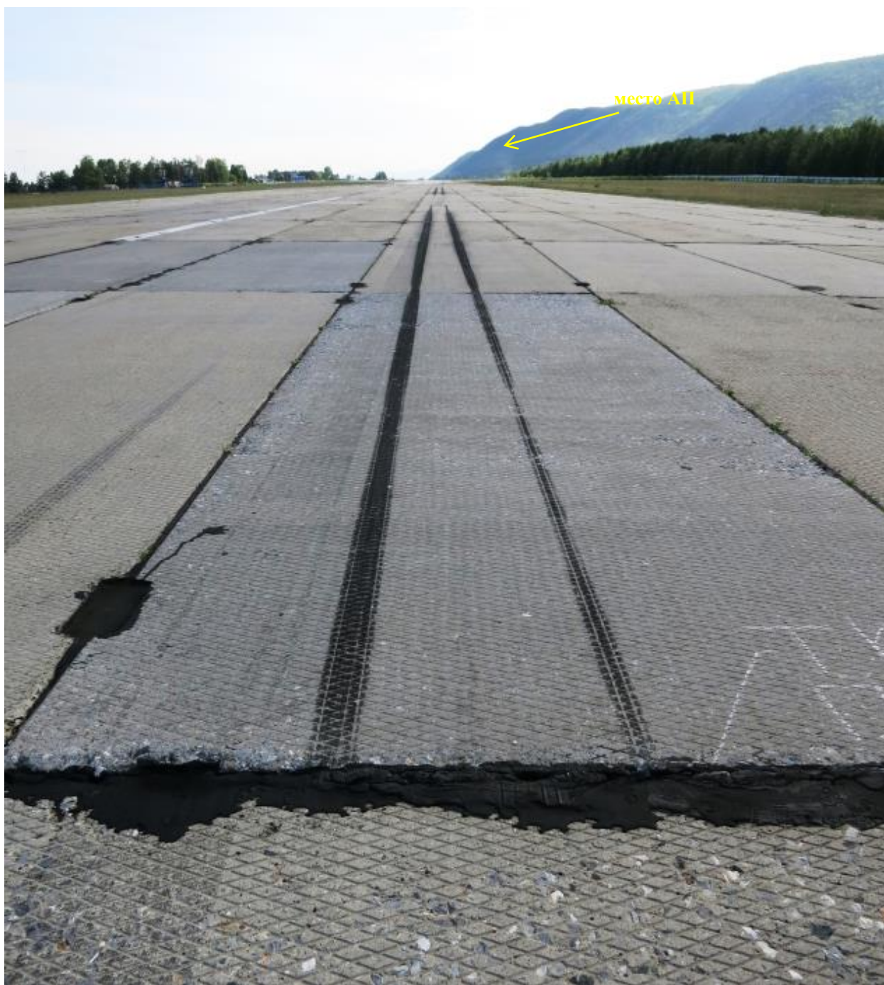
Рис. 10. Следы начала разрушения шин правой основной стойки шасси
