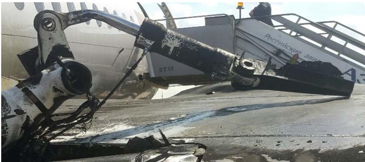
**Рис. 15. Внешний вид гидроцилиндра управления правой ООШ**
