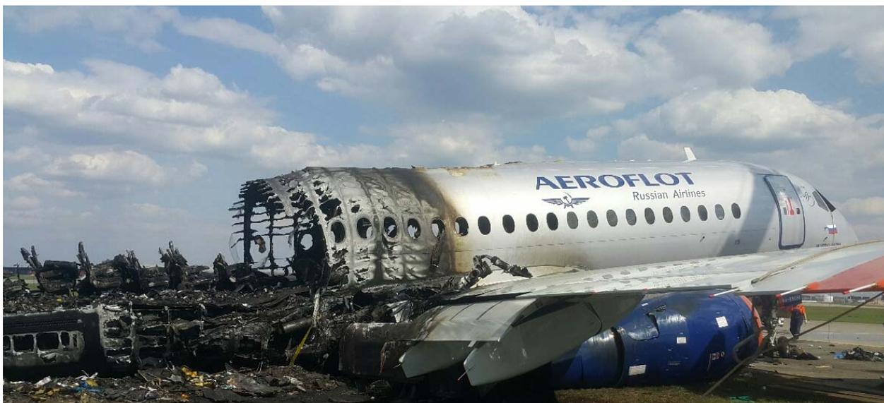
**Рис. 10. Внешний вид передней части фюзеляжа после АП**
