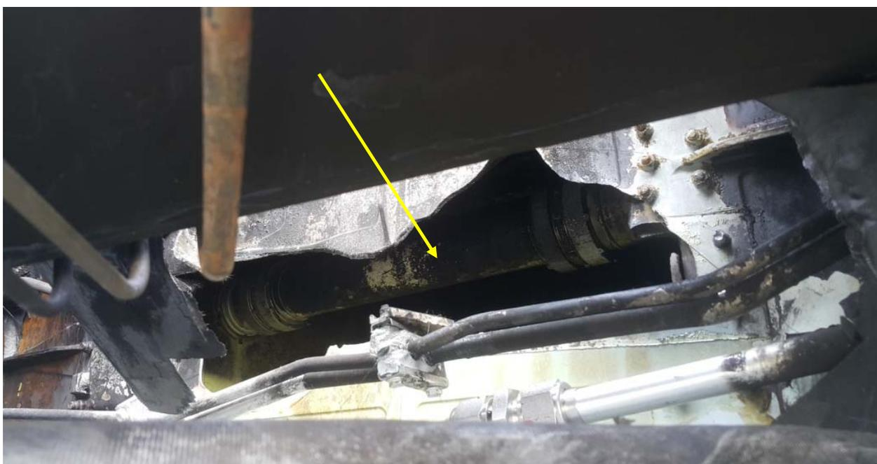
**Рис. 16. Отверстие в стенке лонжерона правой консоли (указано стрелкой)**
