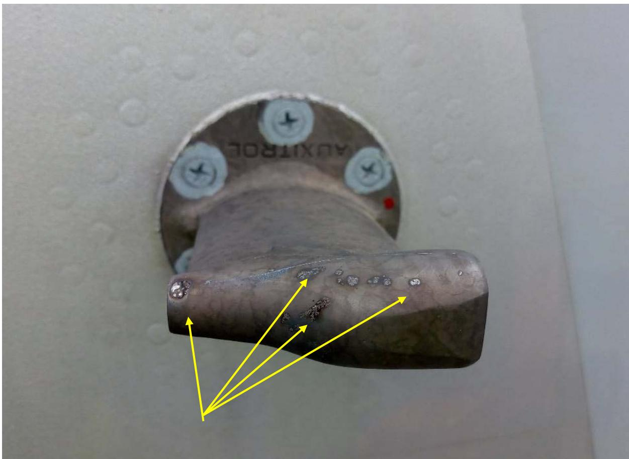
**Рис. 24. Следы попадания молнии в правый датчик температуры**
