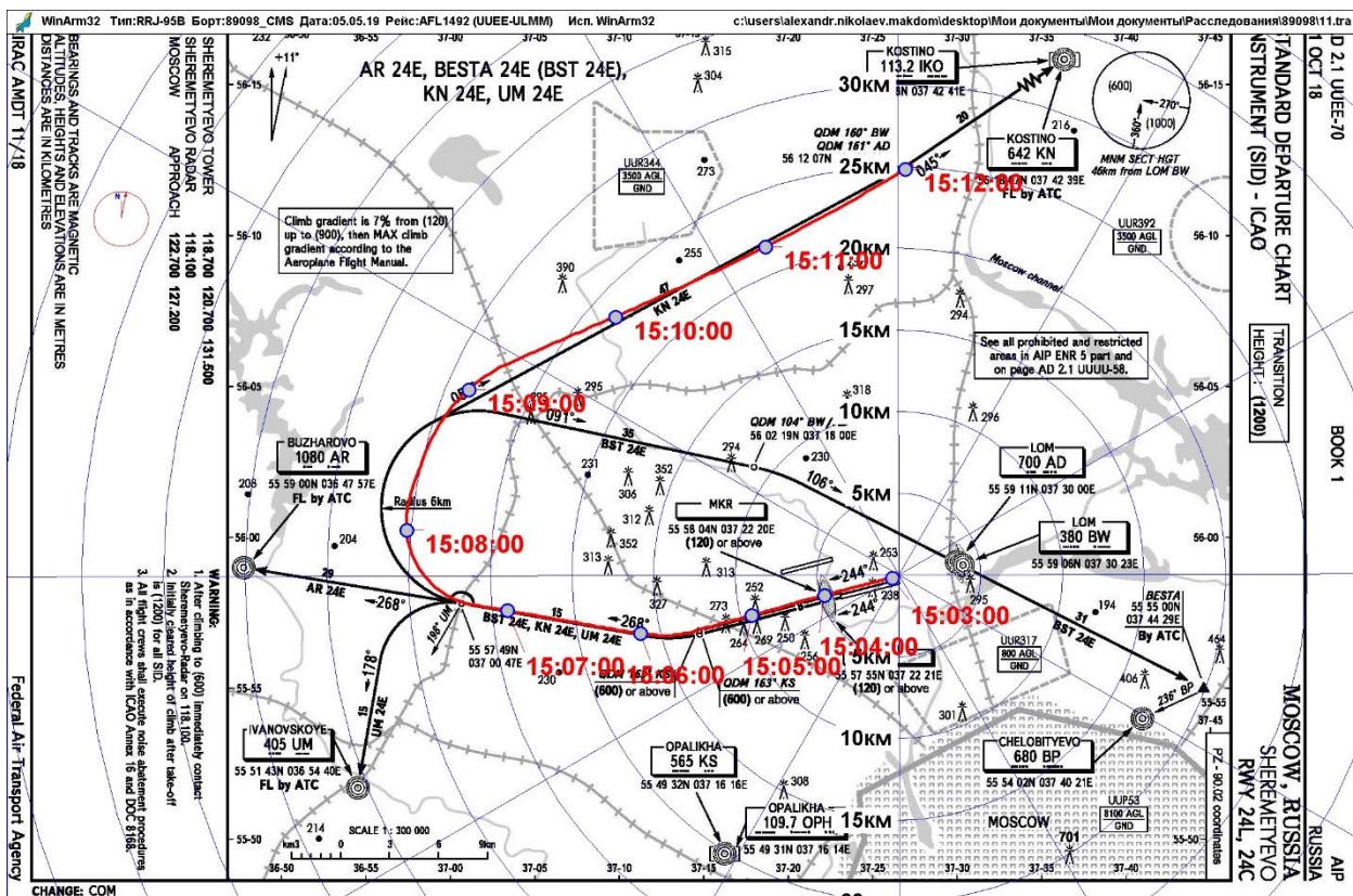
Рис. 4. Траектория полета, совмещенная со стандартной схемой выхода KN 24E
