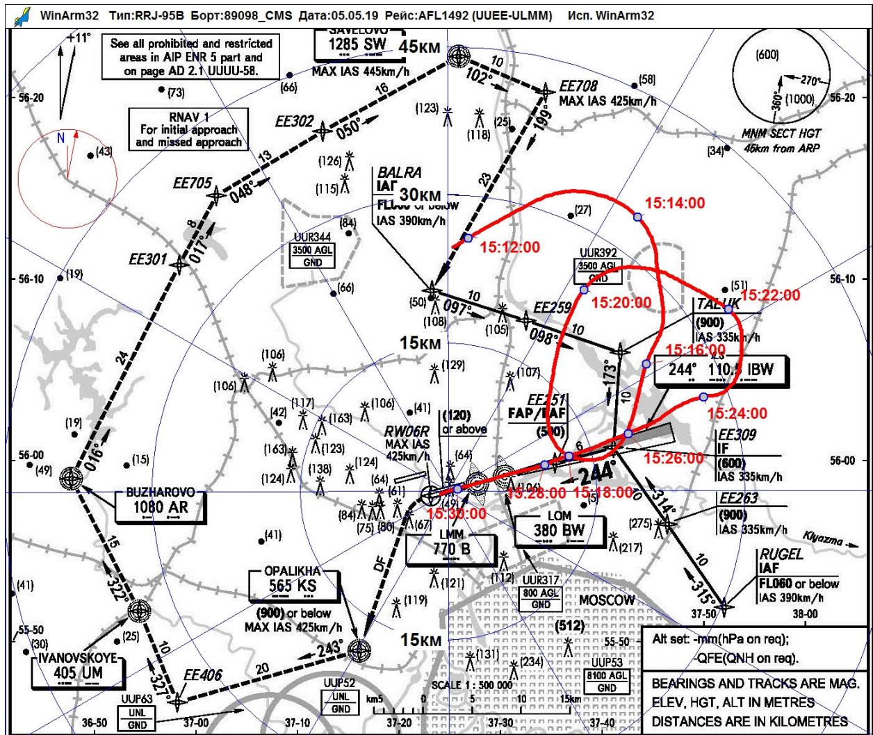
Рис. 5. Траектория полета, совмещенная со стандартной схемой подхода
