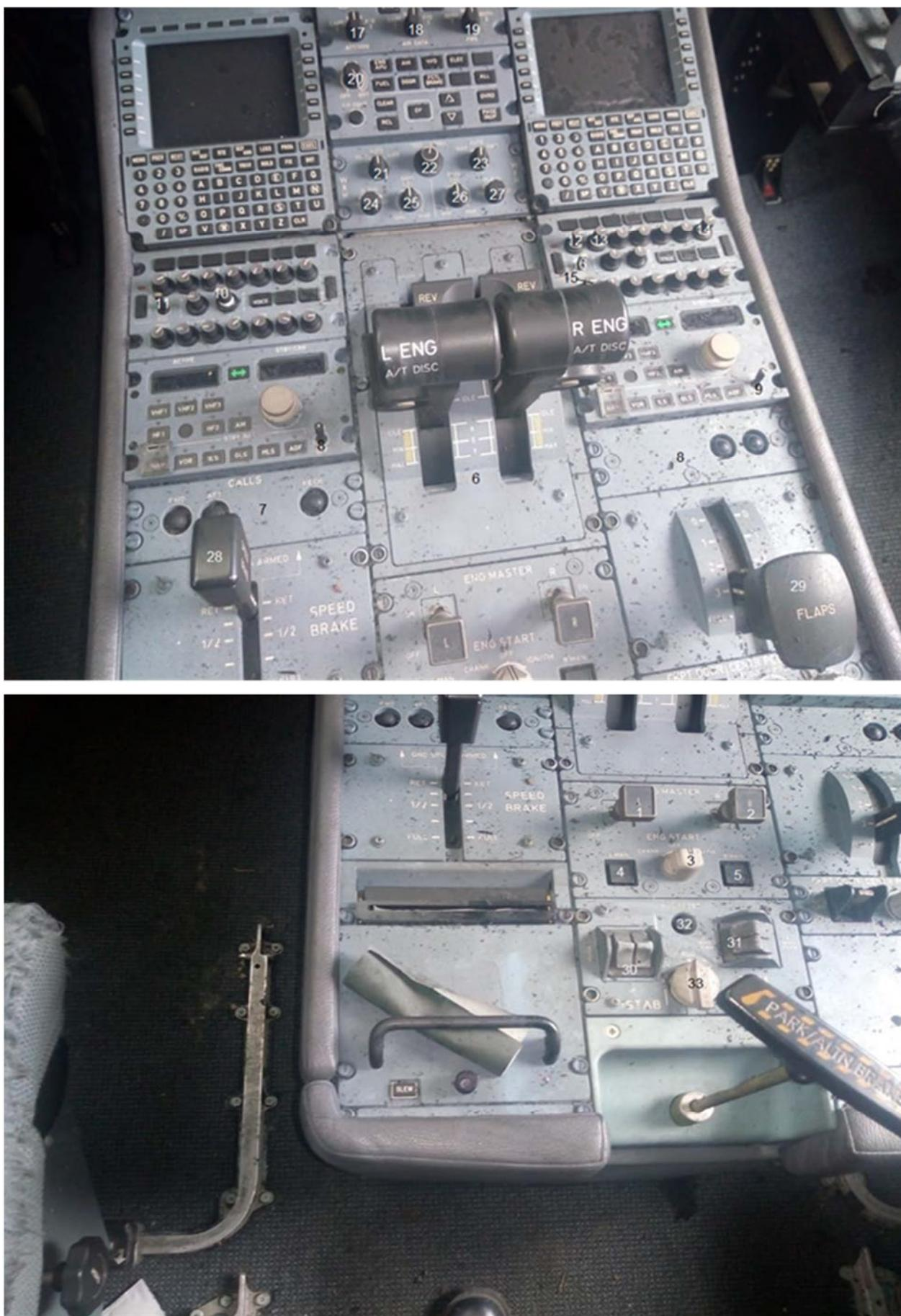
Рис. 20. Состояние переключателей управления двигателями после АП
