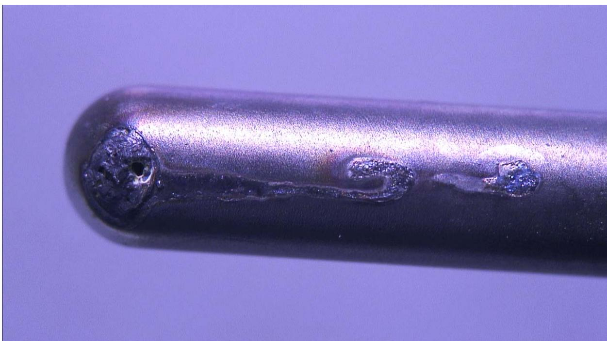
**Рис. 25. Следы попадания молнии в правый сигнализатор обледенения**
