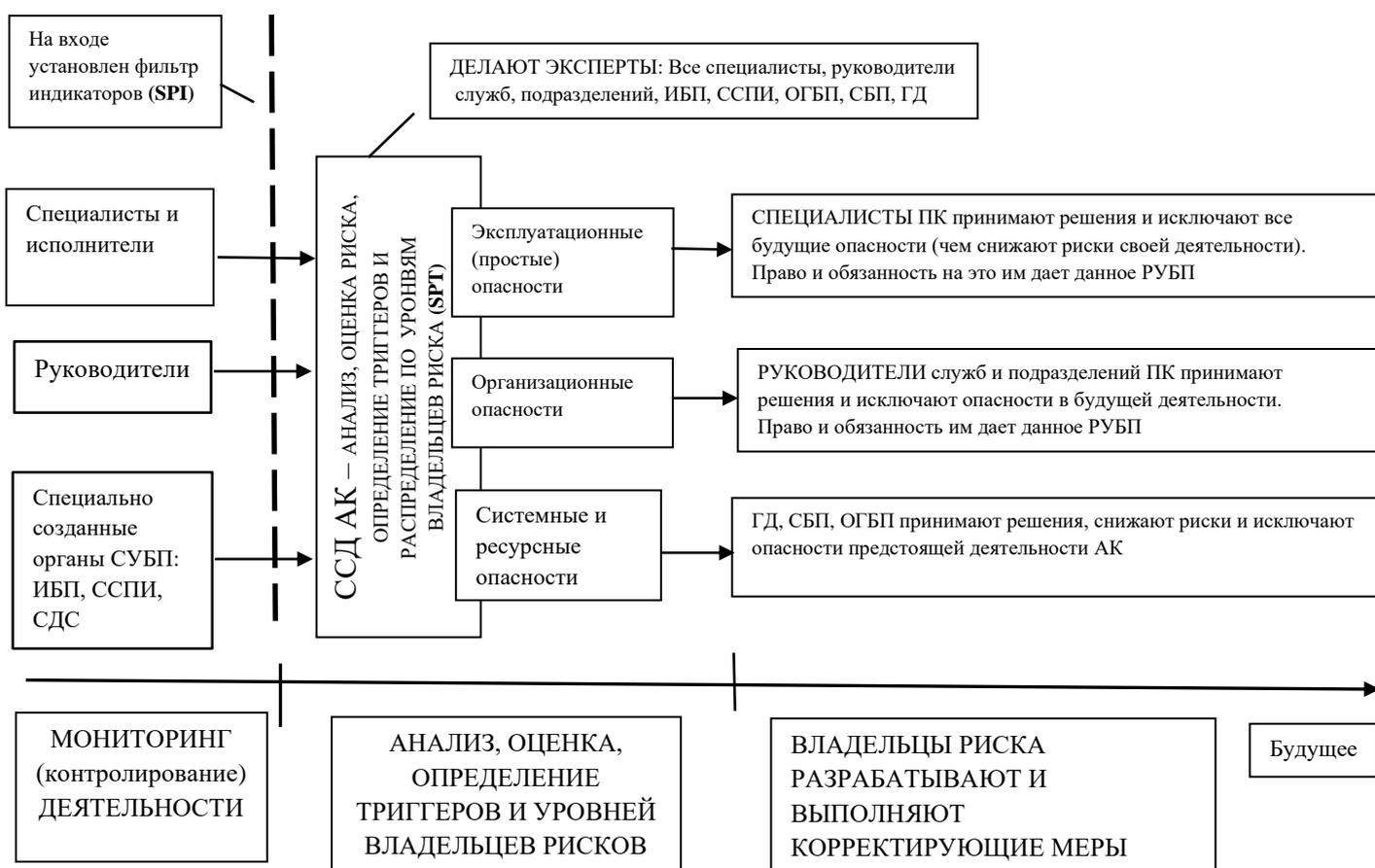
В рамках ОГБП руководители ПК производят мониторинг и анализ опасностей присущих для производственного процесса с учётом данных ССПИ, ИБП, добровольных сообщений и т.д. Каждую зарегистрированную опасность (угрозу) заполняя “Карты контроля работы с опасностями” (ККРО<sup>8</sup>) распределяют по зонам Владельцев рисков. Производят общий контроль рисков деятельности своего подразделения и докладывают его на
